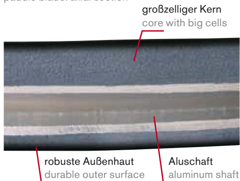
Paddelblatt: Längsschnitt paddle blade: axial section
